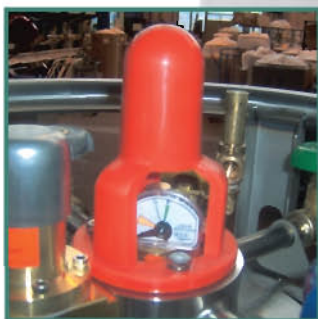
Die Roto-Cal™ Füllstandsanzeige ist ein einfach abzulesendes Instrument mit drehbarer Anzeige.
